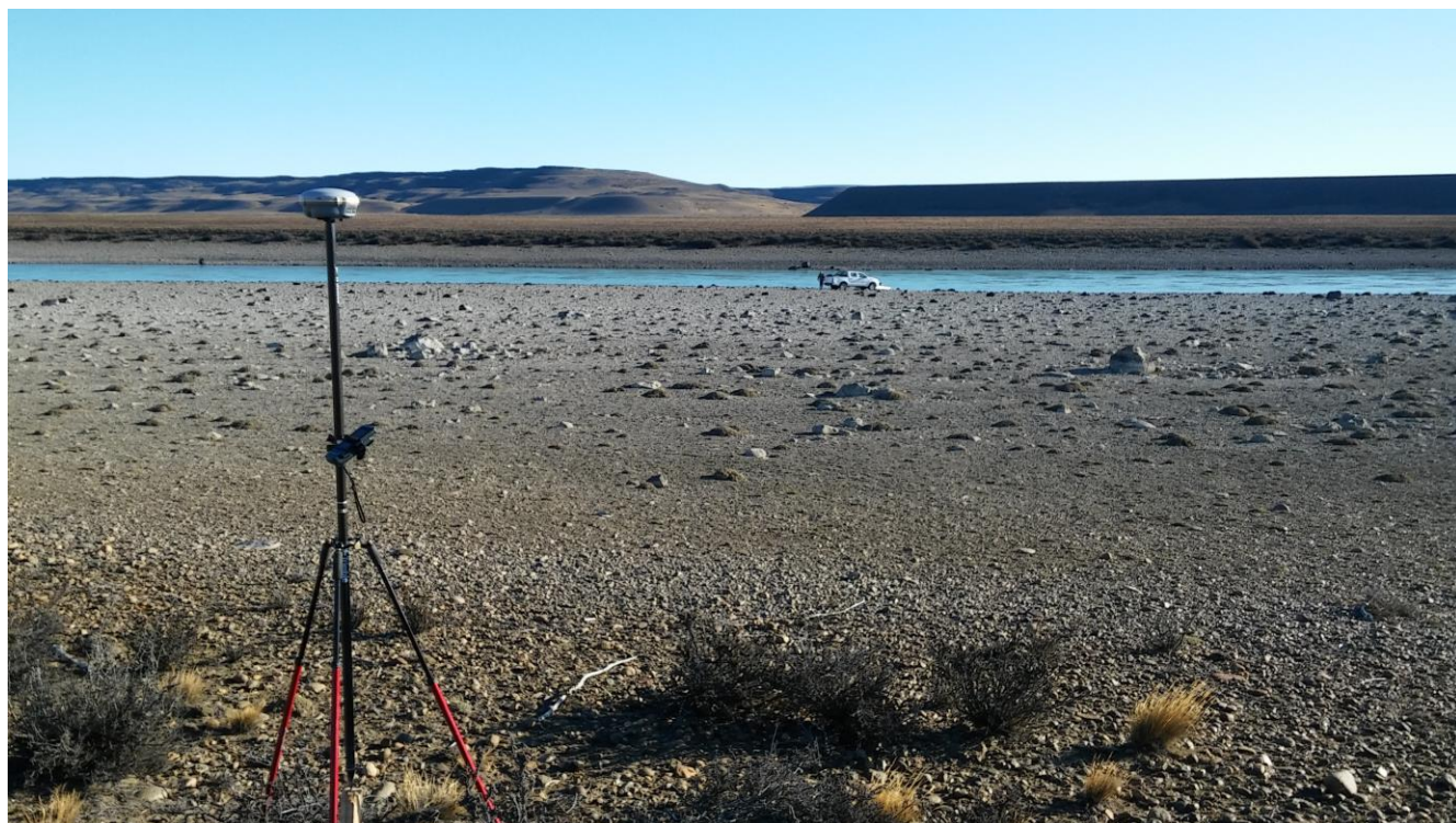
Figura 11 – Ejecución de Relevamiento Estacas con GPS Río Santa Cruz NK, Perfil 40 Ampliación.
