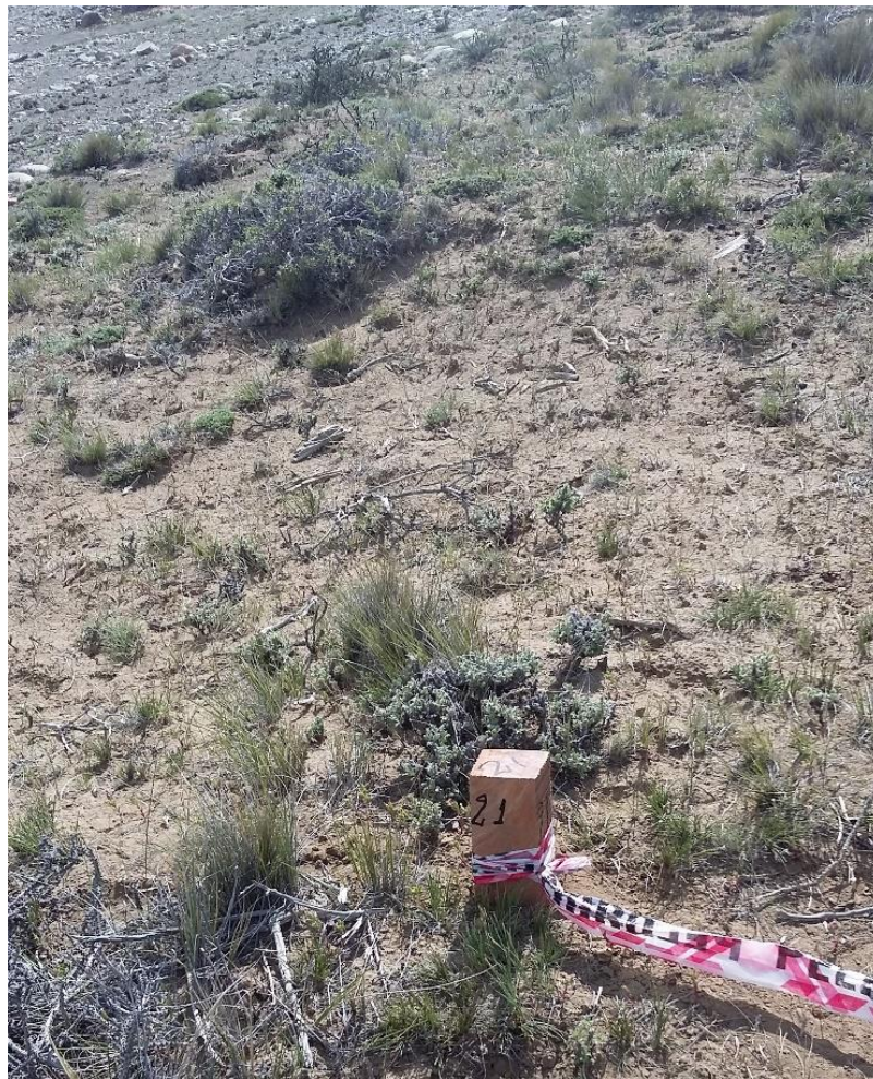
Figura 7 – Estaca correspondiente al perfil transversal N° 21 nivelada
