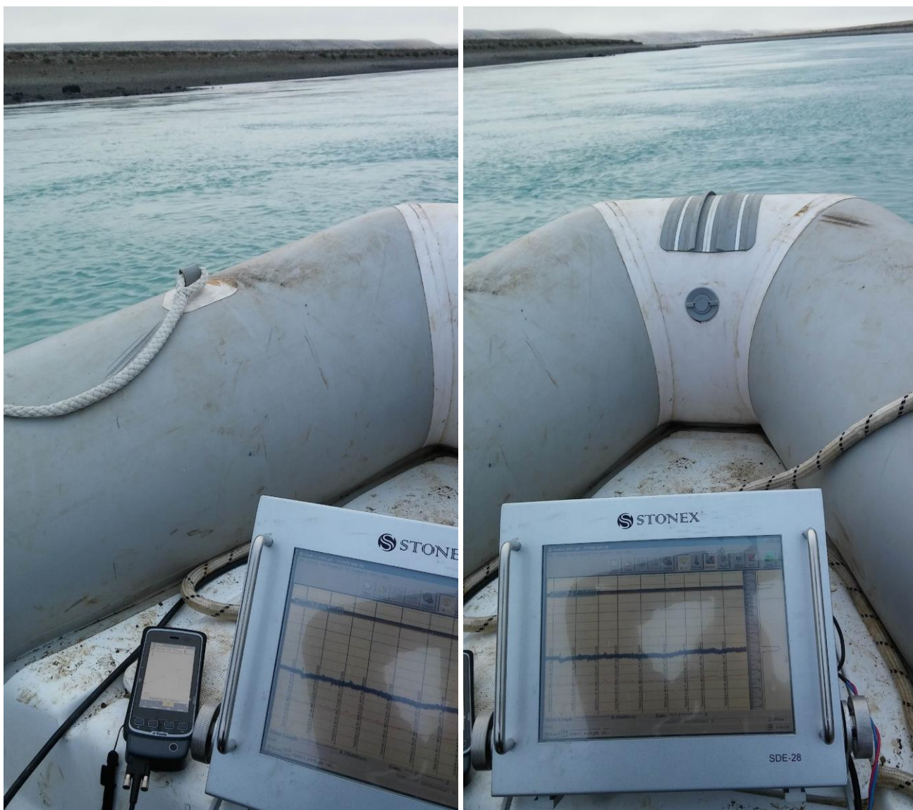
Figura 4 y 5 – Ejecución de Topobatimetría- Perfil 30 - Vista Sur aguas abajo.-
