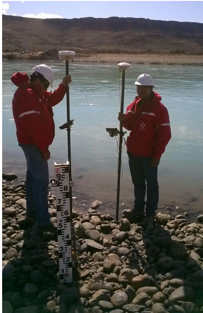
Figura 19 – Relevamientos Pelo de Agua en Regla NK
