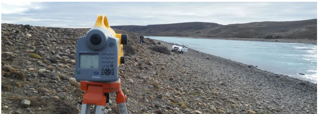
Figura 10 – Ejecución de Nivelacion Geométrica Margen Derecha Río Santa Cruz NK, Perfil 42 Ampliacion.
